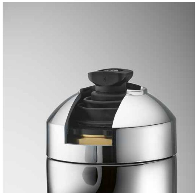
Diese Dichtmembranen lässt die Armatur lange dicht halten. Sie schützt die Steuerpatrone gegen Rückstände von Reinigungsmitteln und Schmutz. Die Hebelaufnahme – durch einen Metallkern verstärkt – ist in der Membrane eingebaut und verhindert zuverlässig, dass sich der Hebel löst.
