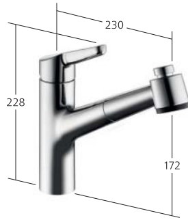
Hebelmischer – Effizienzklasse C – Auszugbrause mit KWC jetclean – bis 700 mm ausziehbar – Rückstellautomatik – Schlauchoberfläche passend zu Armatureoberfläche – Schlauchdurchführung, schwenkbar 130° 10.331.033.000FL chromeline A 230 Auslaufmenge Normalstrahl 11 l/min (3 bar) Auslaufmenge Siebstrahl 11 l/min (3 bar)
