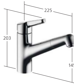
Hebelmischer – Effizienzklasse C – Auszugauslauf – Neoperl® Cascade® – bis 700 mm ausziehbar – Schlauchoberfläche passend zu Armatureoberfläche – Schlauchdurchführung, schwenkbar 130° 10.331.103.000FL chromeline A 225 Auslaufmenge 12 l/min (3 bar)
